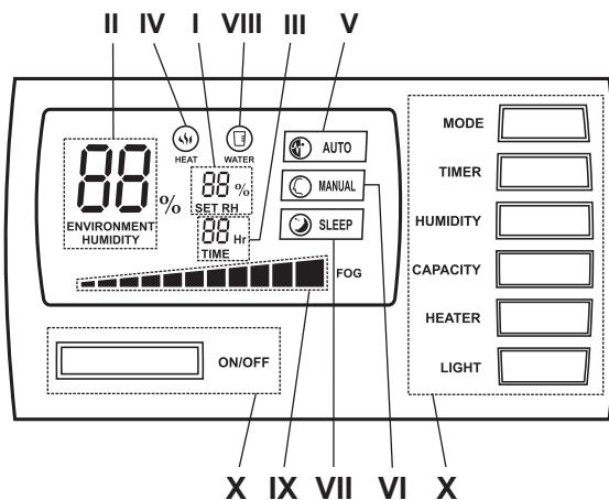
Светодиодный цифровой дисплей. Структурная схема.
